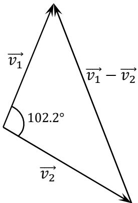
Для вычисления относительной скорости столкновения нам необходимо вычислить модуль разности векторов  $|\vec{v}_1 - \vec{v}_2|$ . Как видно из схемы слева (треугольник равнобедренный,  $v_1 = v_2 = v$ ),
